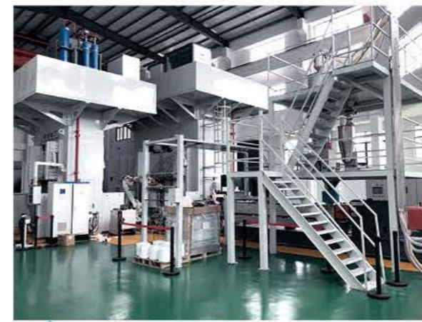
国创中心复合材料在线模压装备
